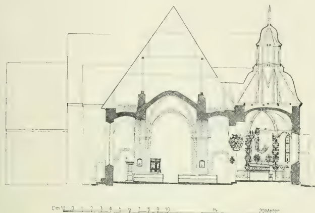
Fig. 24. Tvärsektion genom mittskeppets närmast tvärhuset belägna travée samt Douglas' gravkor. Efter uppmätning av S. Curman o. A. Roland 1907, kompletterad av H. Sundberg 1927.
